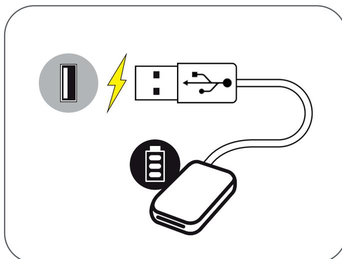
La stampante utilizza una batteria integrata. Prima di utilizzare la stampante, caricare completamente la batteria utilizzando il cavo USB in dotazione.
